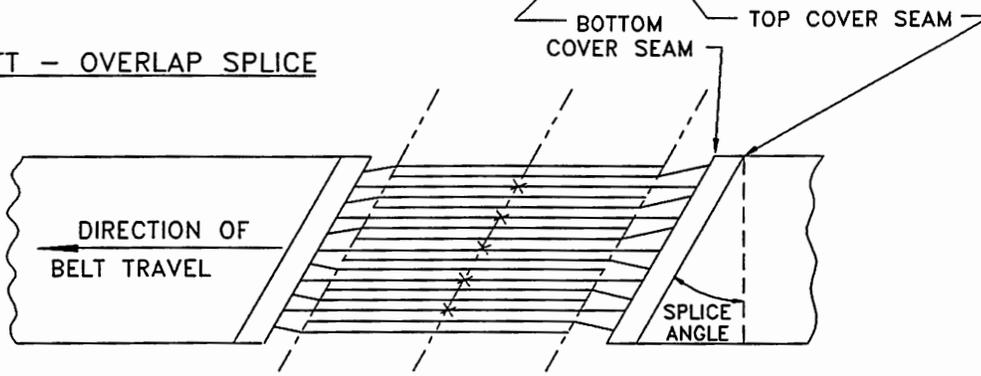
OTHER CABLE PATTERNS COMMONLY USED INVOLVE A GREATER PROPORTION OF BUTTED CABLES WHERE CABLE SPACING IS RELATIVELY CLOSE.
