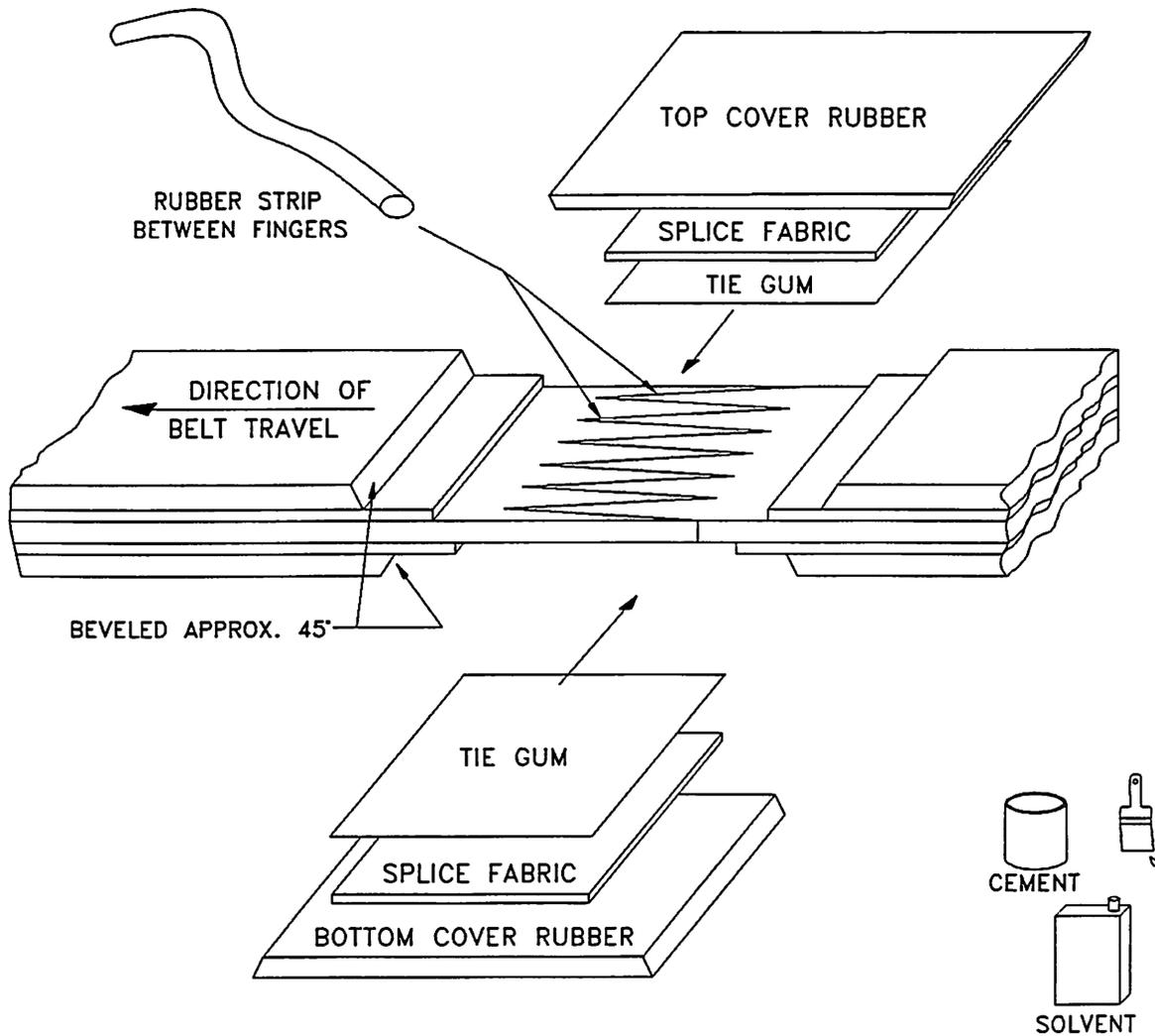
LAY OUT THE SPLICE SO THAT NO TWO SEAMS OCCUR AT THE SAME LONGITUDINAL LOCATION
